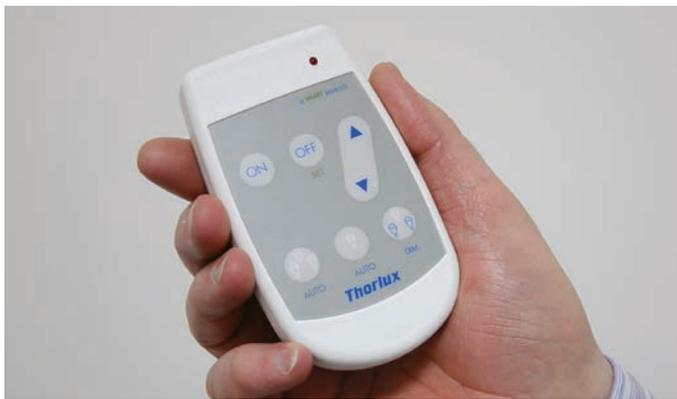
Mit der Smart-Remote von Thorlux können einzelne Leuchten oder die gesamte Gruppe gesteuert werden. Sie bietet volle Kontrolle über die Funktionen Ein, Aus, Dimmen und Aufhellen. Die Smart-Remote wird mit einer einzigartigen, robusten Wandhalterung geliefert. Bei Bedarf ist ein Verriegelungsschlüsselsatz ECO 9724 erhältlich.
